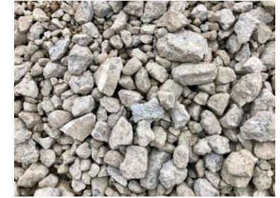
Le béton de recyclage est traité comme un béton à propriétés spécifiées selon SN EN 206:2013+A2 et la norme SIA 262, à condition que les exigences de SN EN 206:2013+A2 et du présent cahier technique soient respectées. L'emploi du béton de recyclage est réglé au tableau 1.
